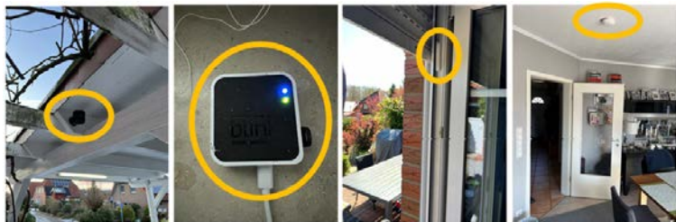
Abb. 4: Smart-Home-Geräte. Von links: Outdoor-Kamera, zugehöriges Sync-Modul (Fa. Blink), verdeckt eingebauter Fenster- und Türkontakt, Alarmsirene (Fa. Homematic). Umsetzung: eigenes Bildmaterial
